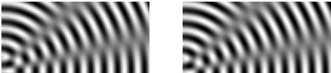
Abbildung 73: Pcolor -Darstellung mit unterschiedlichem shading : links flat , rechts interp .
