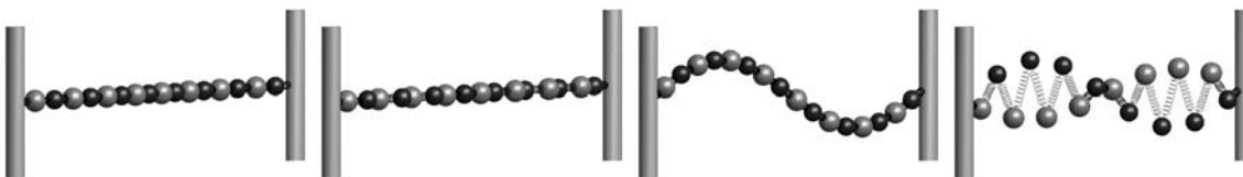
Abbildung 108: 'ChainLA.avi', 'ChainLO.avi', 'ChainTA.avi', 'ChainTO.avi', Schwingungsformen der linearen Kette.
